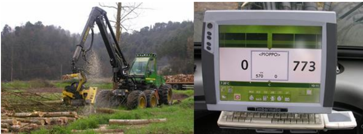
Figura 8. Harvester in fase di lavoro su pioppeto (a sinistra) e computer di bordo (a destra).
