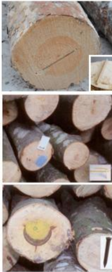
Figura 9. Esempi di tags RFID idonei alla marcatura del legname (tag sperimentale a cuneo, clip, nail tag).
